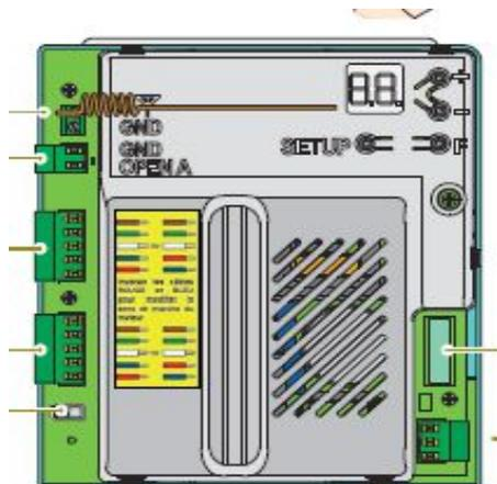
Afin d'augmenter la portée radio, il est possible de rajouter une antenne extérieure réf. 6100012.
